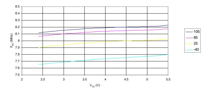
INT RC OSCILLATOR FREQUENCY vs. OPERATING VOLTAGE
